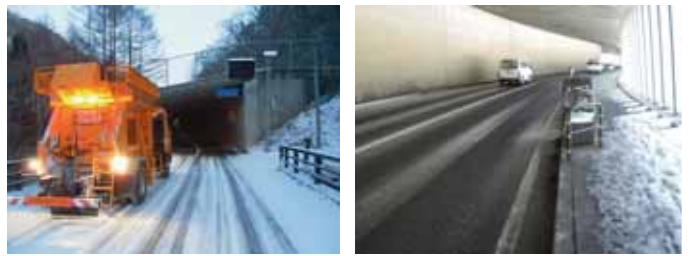
凍結抑制剤散布車の散布状況
