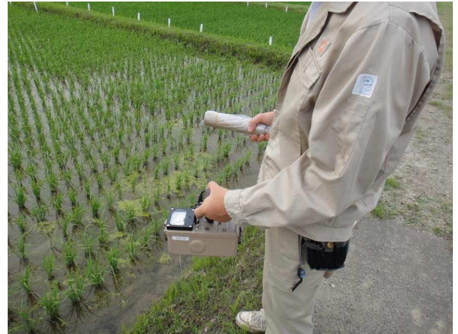
サーベイメータによる空間線量の測定
