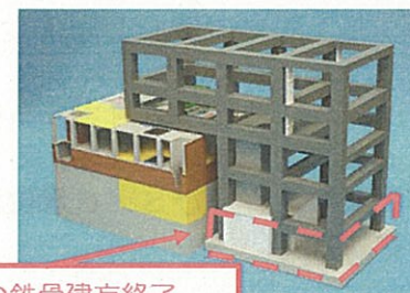
第1節部分の鉄骨建方終了
