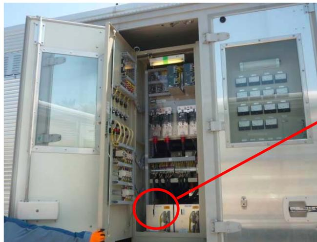
直流制御盤内の充電器基板（制御車）
