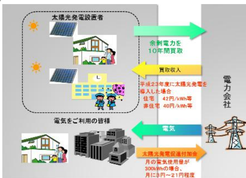
図-1.9 太陽光発電の余剰電力買取制度の仕組み
