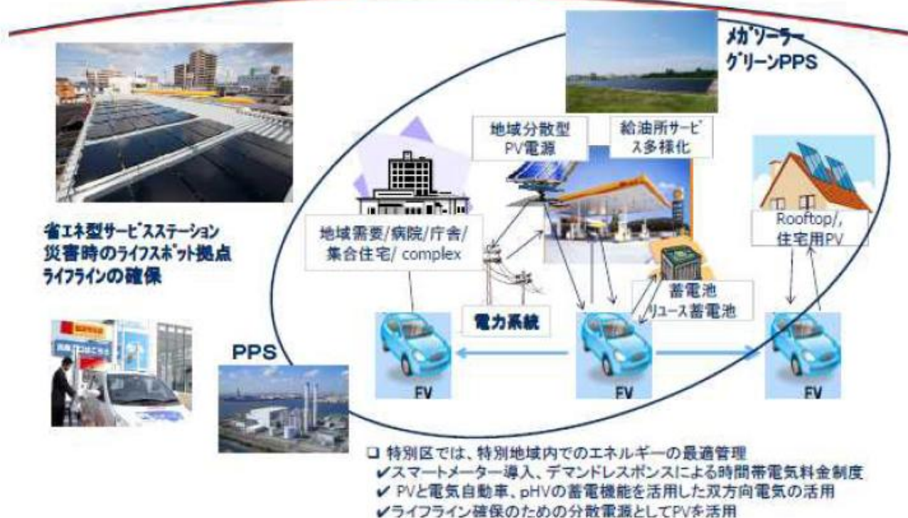
災害時の双方向エネルギー活用のイメージ図 (ソーラーフロンティア(株)提供)
