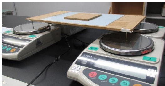
写真6. 作成した重心測定装置。平板の上には方眼紙を貼り、重心位置を測定する物体 (直方体の木材) をのせている様子。
