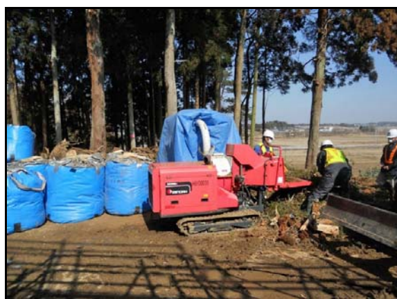
枝打ち後の破碎及び袋詰め
