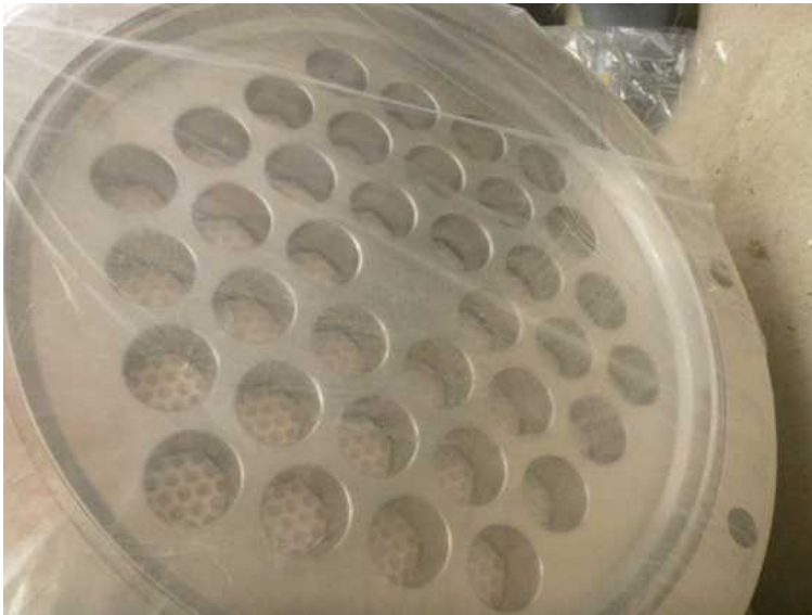
○多核種除去設備（ALPS） （クロスフローフィルタの フィルタ部拡大写真）
