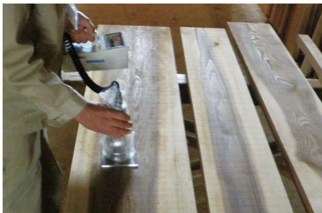
写真4-2 木材の表面線量測定状況
