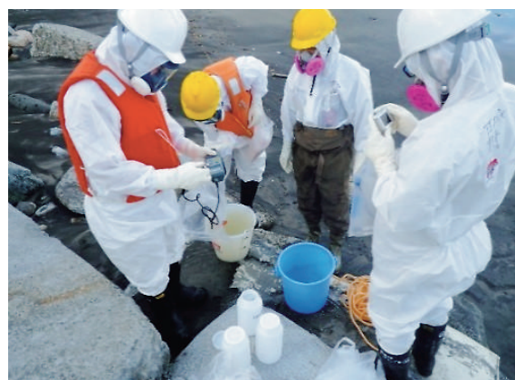
A排水路放水口付近における海水採取状況確認
