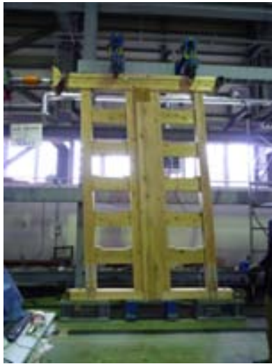
写真1 高倍率耐力壁の実験状況
