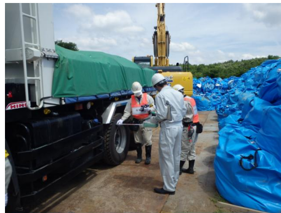
運搬車両の空間線量率の測定
