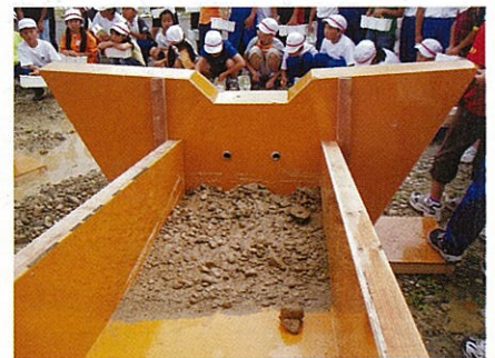
模型を使った土石流の再現
