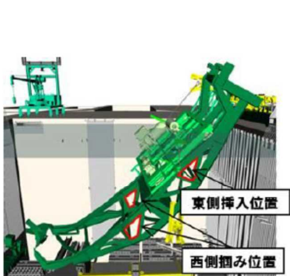
1)FHM ブリッジ東側吊り具吊下げ
