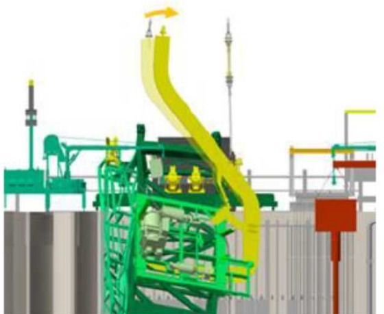
3)FHM ブリッジ東側吊り具角度調整
