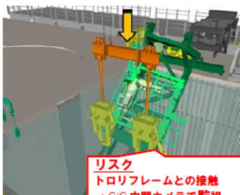
6)FHM 取扱具を FHM ブリッジ西側まで吊下げ
