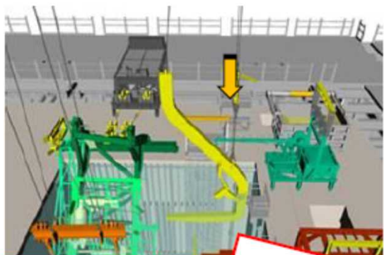
1)FHM ブリッジ東側吊り具吊下げ
