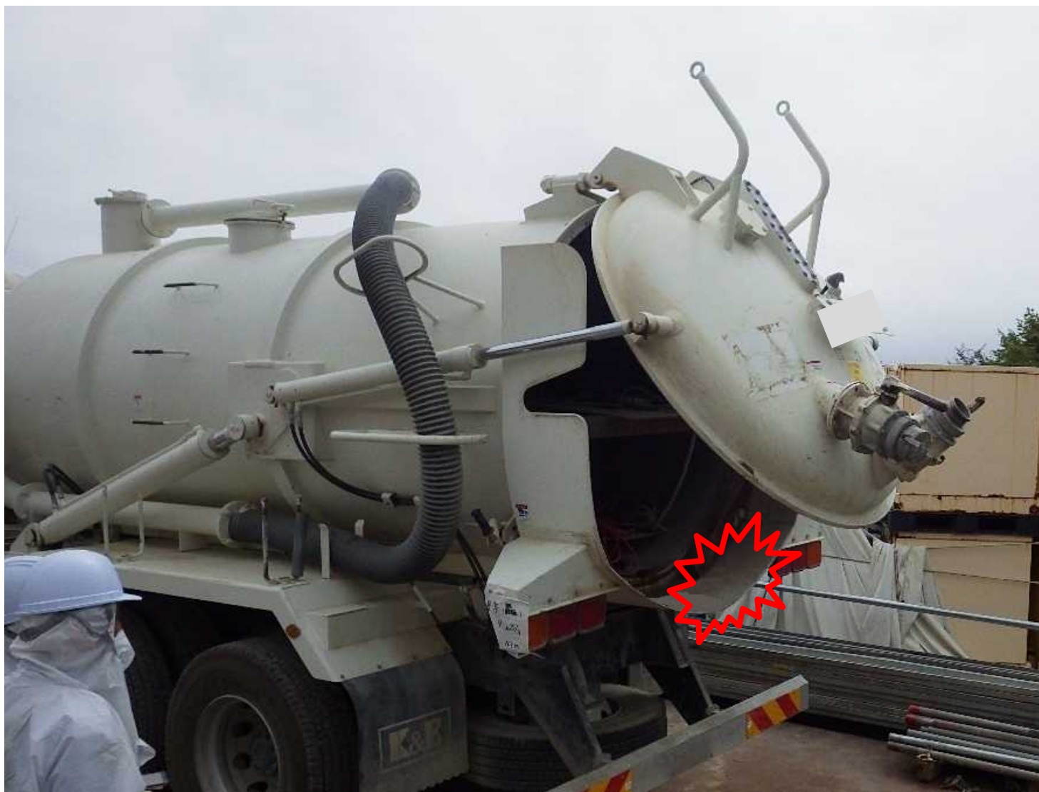
後部タンク蓋開閉動作の確認状況
