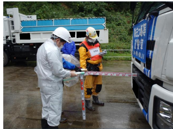
運搬車両の空間線量率の測定
