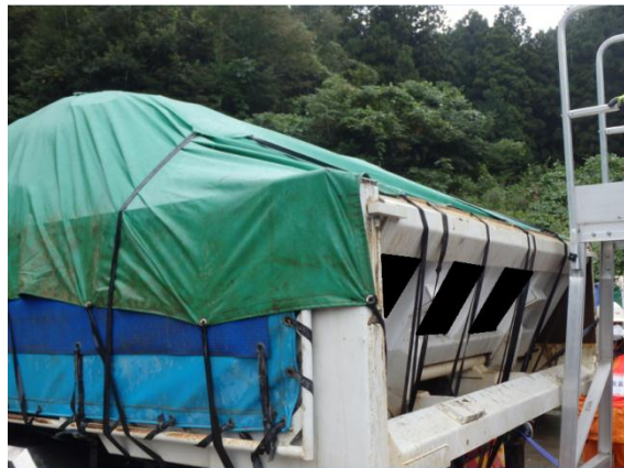
荷台シートの固定状況確認
