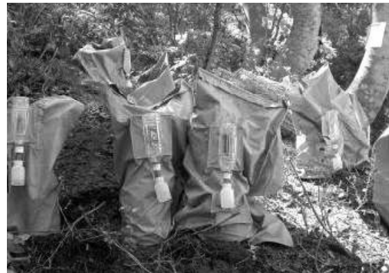
写真-8 カシノナガキイムシ採取用の袋状ターポリンシート製羽化トラップ
