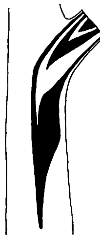
図-7 樹体縦断面における心材腐朽の進展経過 (模式図)
