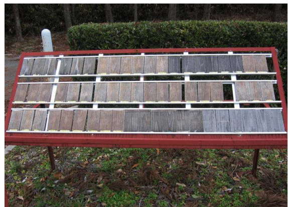
写真-1 屋外曝露状況 (22ヶ月経過)
