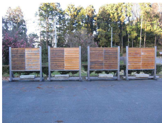
写真-2 外壁パネルの屋外曝露状況(2年経過)
