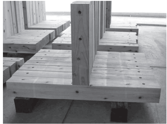
写真-3 柱頭柱脚試験体
