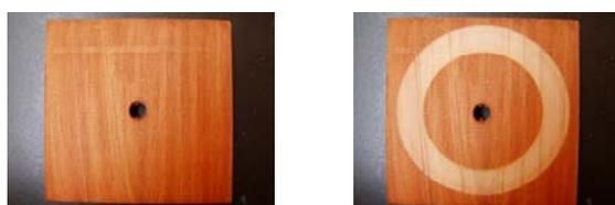
写真-20 耐摩耗性試験試験体 (左：試験前、右：試験後)
