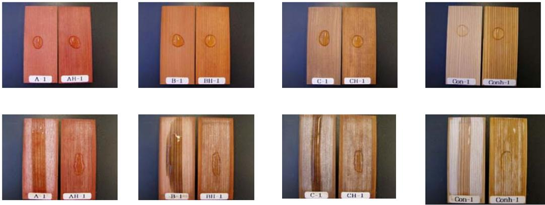
写真-19 促進耐候試験写真（上：試験前、下：1,100 h 経過後）
