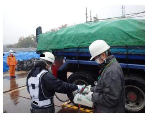
輸送車両の空間線量率の測定
