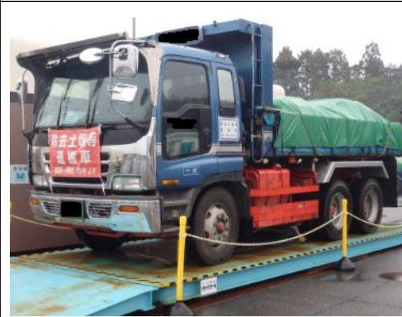
輸送車両の重量測定状況の確認
