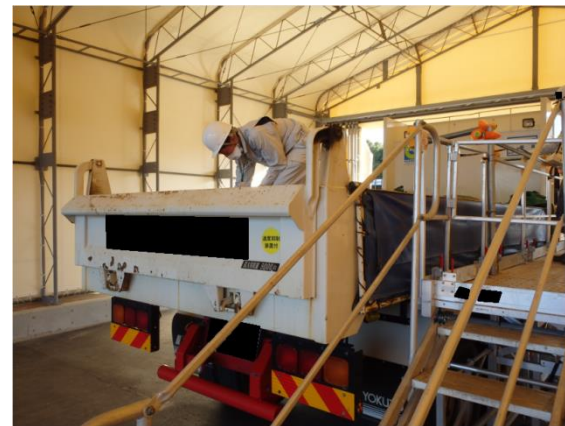
保管場からの退場車両の線量測定
