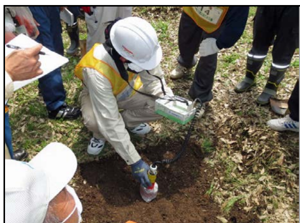
コリメータ使用し線量確認
