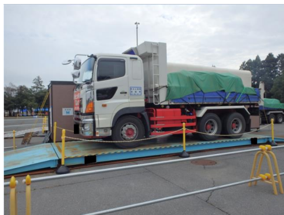
輸送車両の重量測定状況の確認
