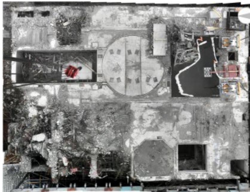
オペフロ大型瓦礫撤去完了後（撮影日2014年1月31日）
