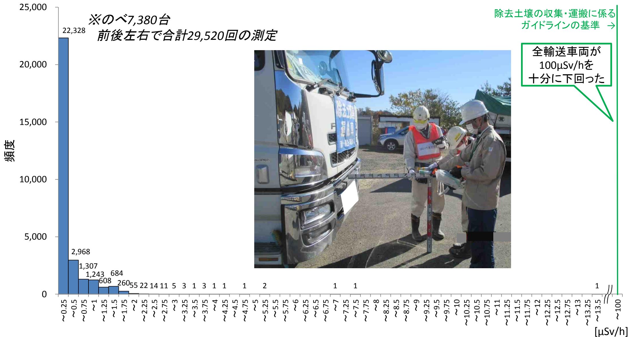
輸送車両周辺の空間線量率の測定結果(平成28年3月22日時点)
