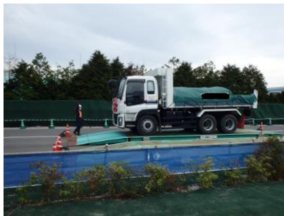
保管場内到着時の重量測定
