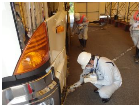
保管場からの退場車両の線量測定
