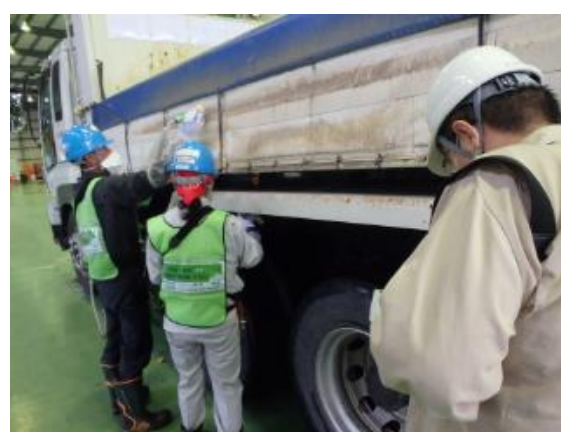
保管場からの退場車両の線量測定
