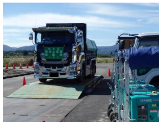
保管場内での輸送車両の重量測定
