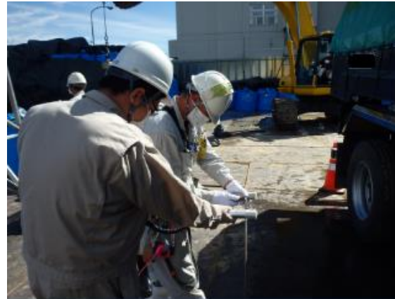
輸送車両の空間線量率測定
