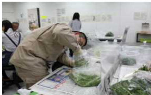
⑥ 隙間ができないよう、容器に試料を詰め込む
