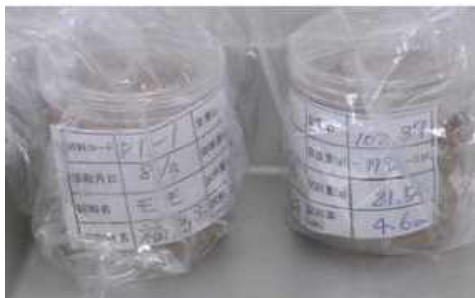
⑧ ゲルマニウム半導体分析器の汚染防止のため、容器をビニール袋で包む
