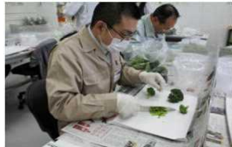
④ 試料をできるだけ細かく刻む
