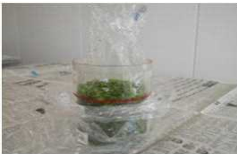
⑥ 隙間ができないよう、容器に試料を詰め込む
