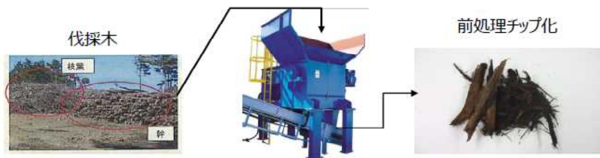
図17 焼却炉前処理設備
