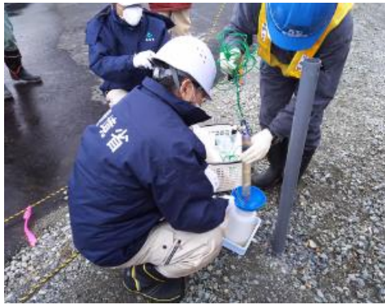
地下水観測井の確認（大熊町）
