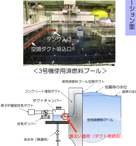
<空調ダクトからの水漏れ箇所 (3号機の例) >
