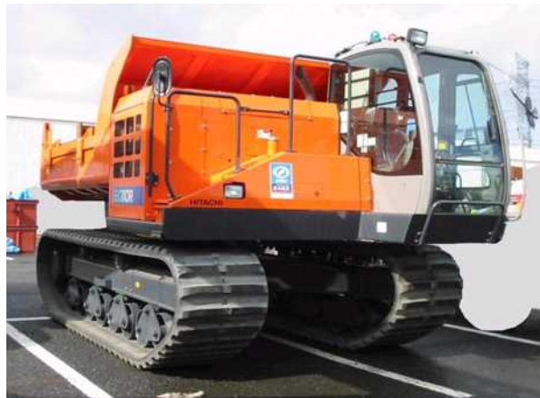
クローラダンプ (可搬式消防ポンプ、 仮設ヘッダーを運搬)
