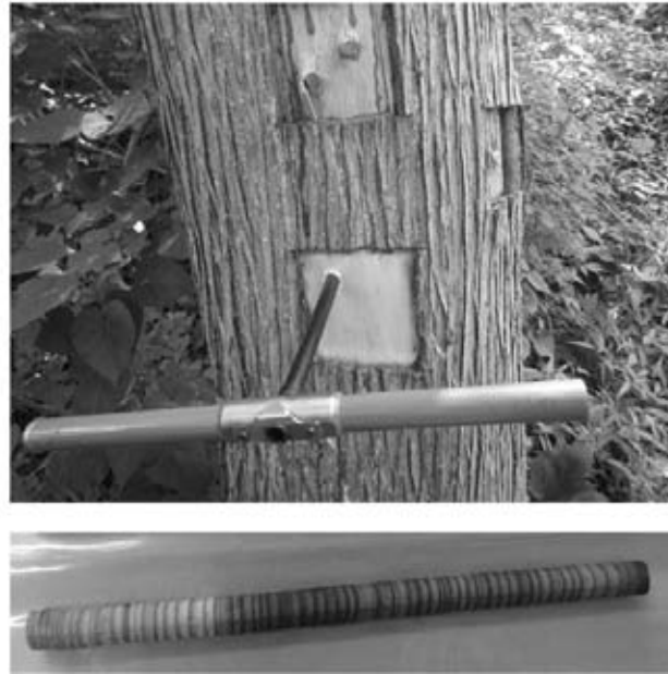
図－1 成長錐を用いたスギ立木からの材の採取状況（上図）と、採取した材サンプル（下図）
