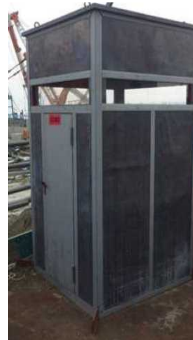
待機用鉛遮へい小屋
