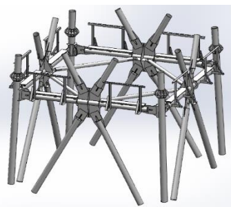
鉄塔単体の解体ブロック例 ※鉄塔単体の場合も同じ装置を使用
