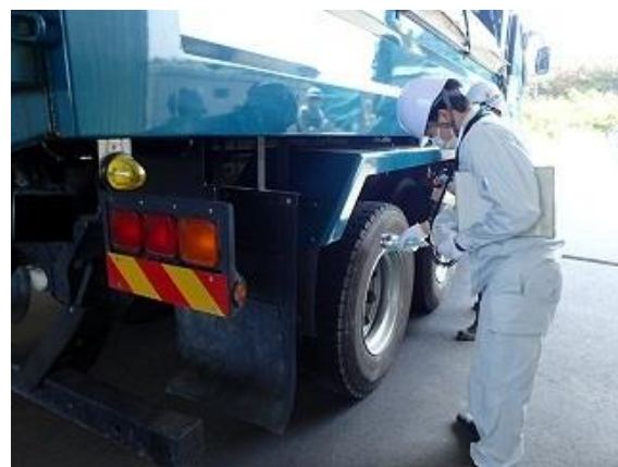
保管場からの退場車両の線量測定
