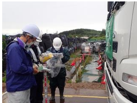
輸送車両の空間線量率測定
