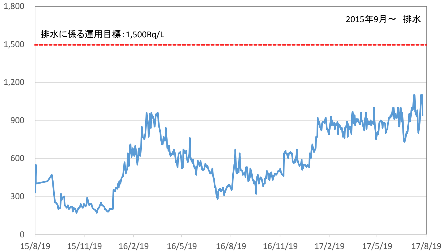
サブドレンー時貯水タンク トリチウム濃度 (Bq/L)
