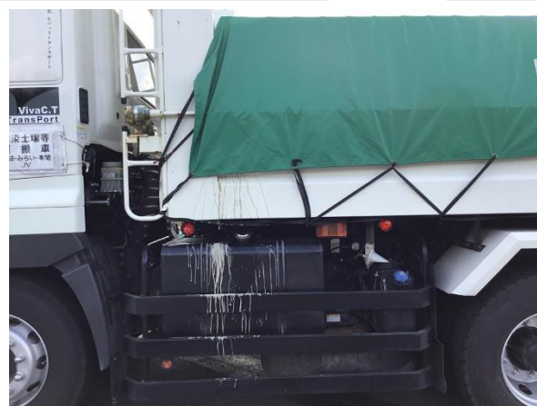
車両及び大型土のう袋からの濁水の状況(2台)
