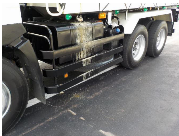
車両及び大型土のう袋からの濁水の状況(2台)
