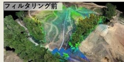
UAVレーザ計測によるグランドイメージの作成
