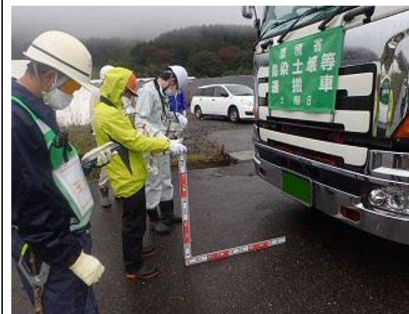
輸送車両の空間線量率測定
