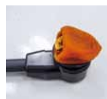
センサーで糖度・水分などを測定
