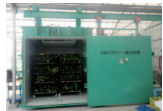
高濃度炭酸ガス大量処理装置
