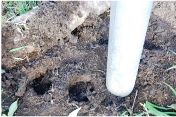
図3 円筒形採土器による剥離下3cmの土壤採取
