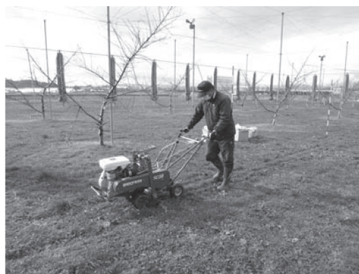
図2 共栄社製 歩行型振動式芝生スライス機
