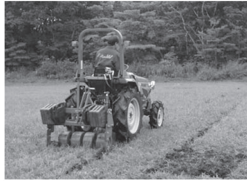
図8 牧草地における土壌切削装置の試験
