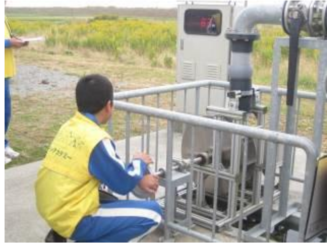
<水車を人力と水力で回したときの発電量の違いを比べる>
